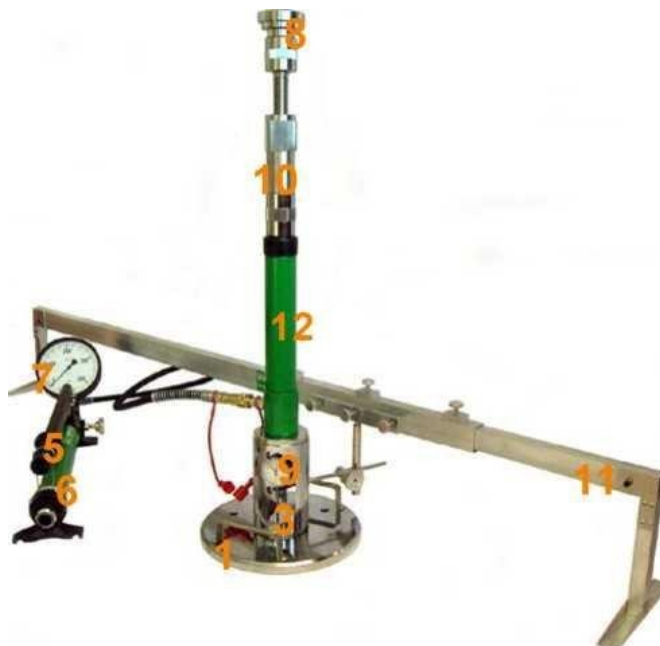
Rys. 1.1. Aparatura VSS z trzypunktowym pomiarem przemieszczenia płyty
