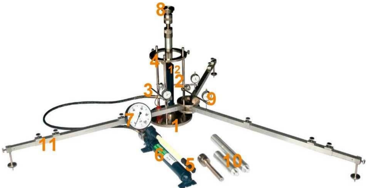
Rys. 1.1. Aparatura VSS z trzypunktowym pomiarem przemieszczenia płyty
